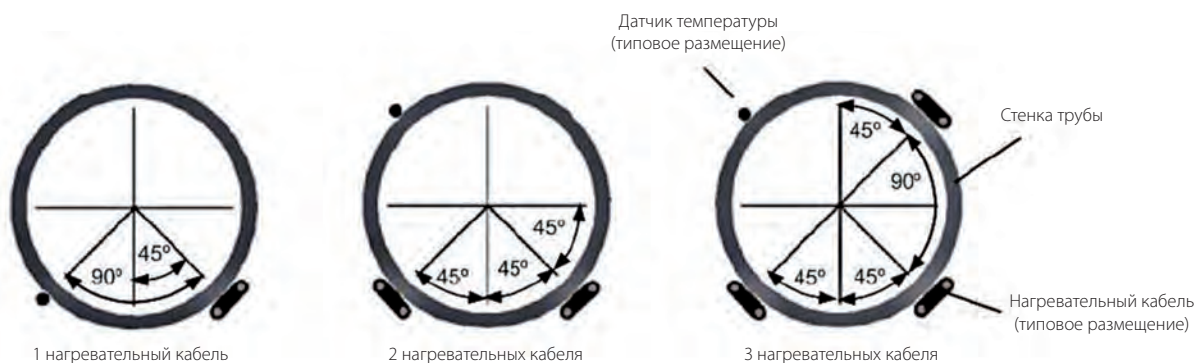
Рисунок В. Положение нагревательного кабеля относительно датчика
