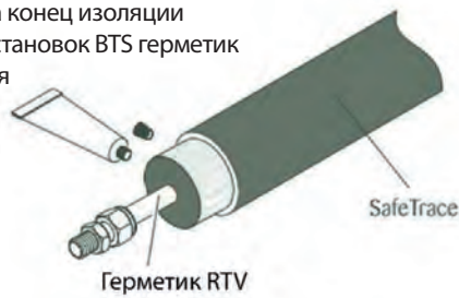
Иллюстрация I: Выполнение сращивания с помощью набора FAK-8
