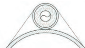
Типовое сечение DLS-IT (Спутник крепится к трубе лентой FT-1H)
