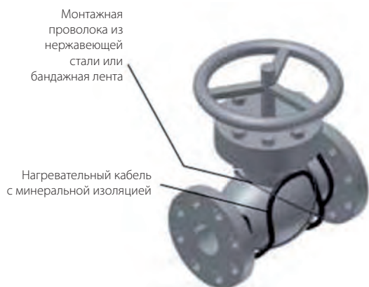
Прокладка петлями нагревательного кабеля на задвижке
