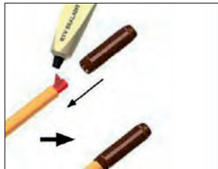
4c. Нанесите внутрь концевой заделки и на конец кабеля [как минимум на 3 мм (0,12 дюйма)] клей RTV. Наденьте концевую заделку на конец нагревательного кабеля.
