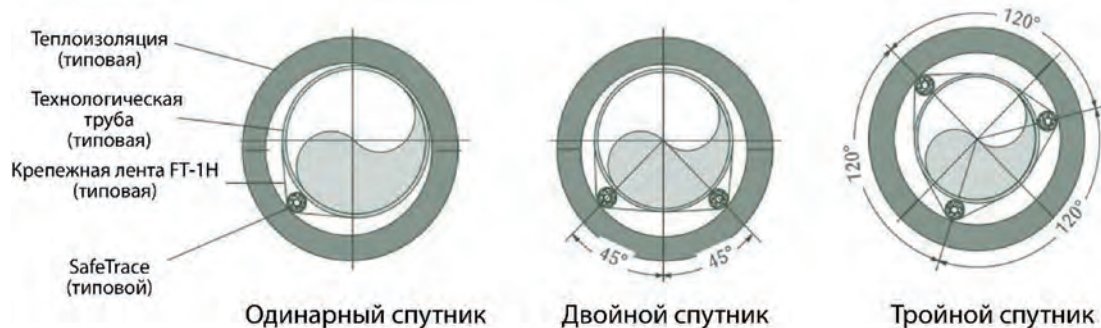
Иллюстрация С: Место спутника (См. пункт 2 инструкции по монтажу выше)
