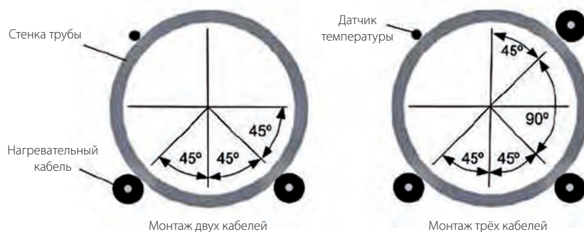
Рис. В. Рекомендуемая ориентация нагревательного кабеля и расположение датчика
