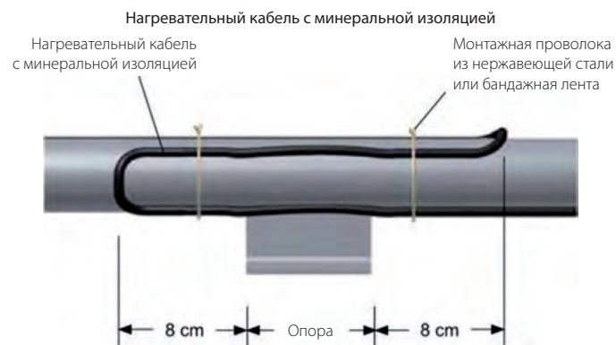
Иллюстрация D: Опора трубопровода
