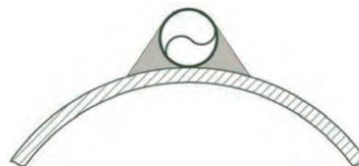
Сечение типовой установки (Галтельное нанесение)
